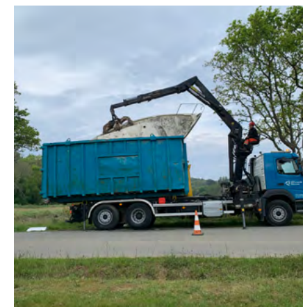
Enlèvement par camion grappin puis dépose en centre de traitement agréé.
